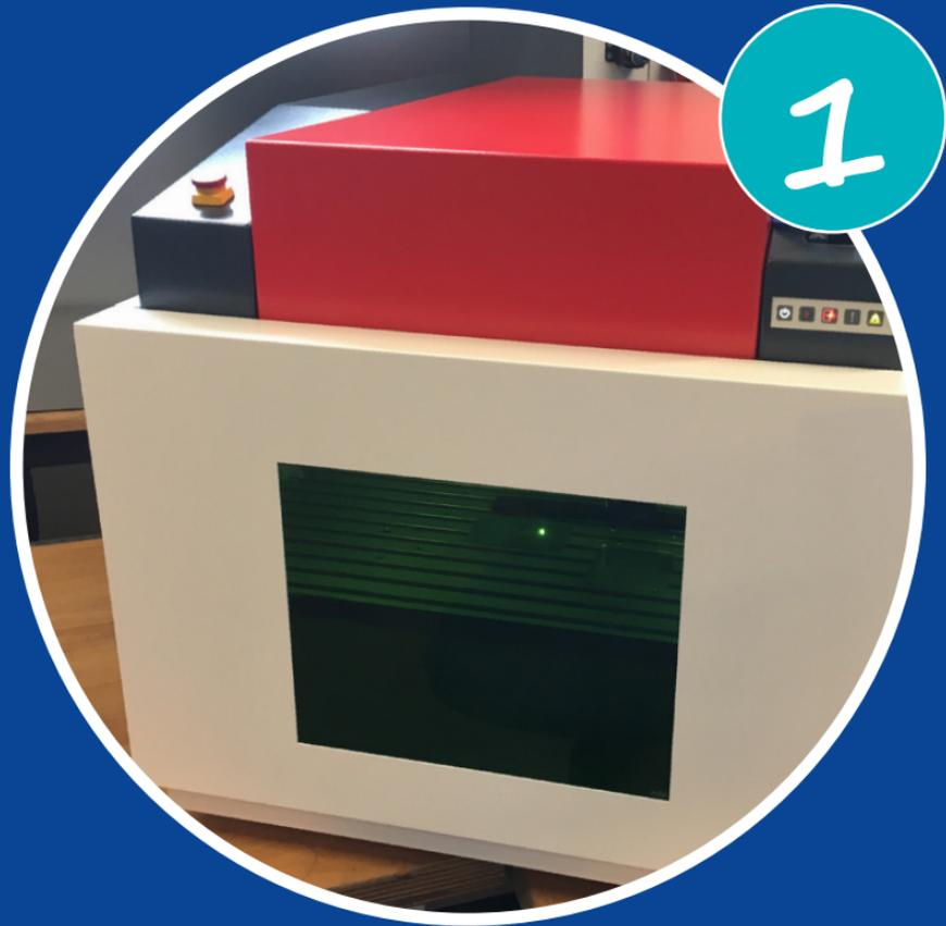
Komplett eingehaust und mit technischen Schutzmaßnahmen ausgestattet kann ein Laser sicher betrieben werden
